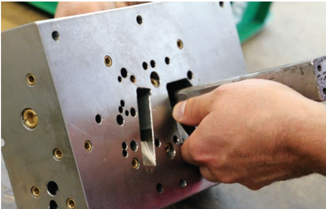
Muss auf Antrieb passen: Die erodierten Teile werden im Werkzeugbau bei fischer automotive systems nicht mehr nachgearbeitet
