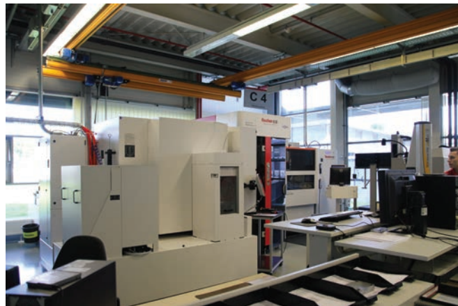
Die Zelle mit den CUT-P550-Erodiersystemen von GF Machining Solutions mit dem automatisierten Werkstückhandling Workpartner 1+ in der Mitte.
